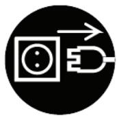
**Avant d'ouvrir le compartiment du réservoir, coupez l'alimentation électrique.**
