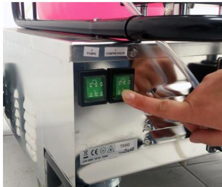
2. Vous devez attendre environ 1 à 2 minutes que le réservoir d'air se remplisse. Une fois rempli, le compresseur s'arrêtera. La pression doit être d'environ 5,5 bars. Normalement, vous n'avez pas à régler la pression (3), elle a été réglée à la fabrication pour un fonctionnement optimal.
