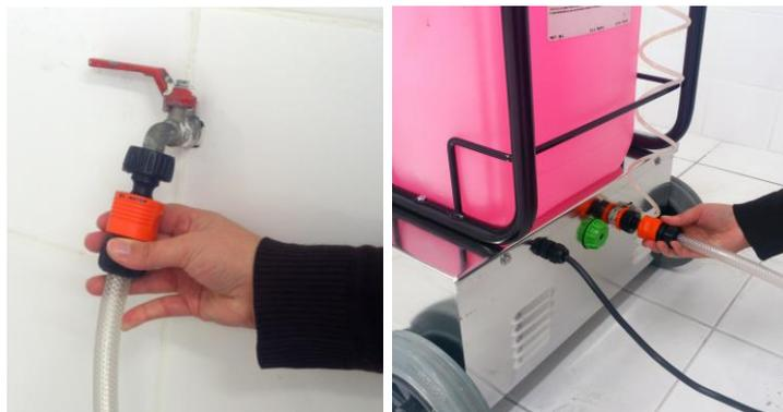
3. Contrôler que le tuyau qui plonge dans le bidon de produit est bien raccordé à l'entrée de produit sur le panneau de commande (7) et contrôler également que le bidon de produit n'est pas vide.
