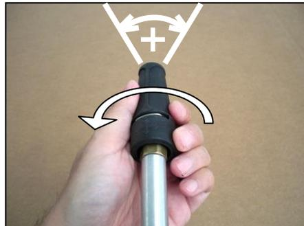
3. Appuyer sur la gâchette. Nous suggérons de rincer les surfaces de haut en bas. En pivotant l'extrémité de la lance, il est possible de varier la largeur du jet de rinçage.
