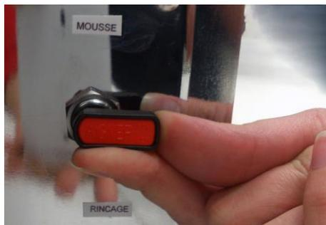
5. Positionnez l'extrémité de la lance mousse/rinçage dans la position « Mousse », en poussant vers l'avant le bout de la lance.
