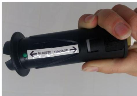
6. Pour pulvériser la mousse, appuyer sur la gâchette située sur la lance. En pivotant l'extrémité de la lance, vous pouvez faire varier la largeur du jet de mousse. Pulvériser le produit sur la surface à nettoyer, de manière uniforme, en maintenant la lance à une distance de 30-40 cm de la surface. L'épaisseur idéale de la mousse est d'environ 3-4 cm.
